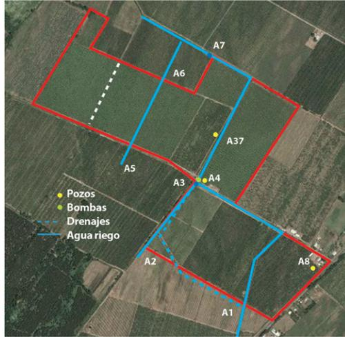
Figura 15. Entradas y salidas de agua del predio estudiado en la comuna de Molina, durante las temporadas 2009 a 2012.
